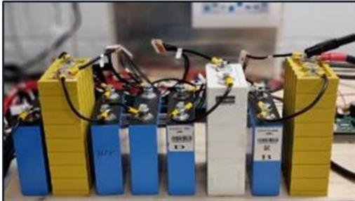
**Bild 1:** ETA-Leveling ist die Lösung für den Betrieb ungleicher Zellen – egal ob direkt ab Werk oder in Second-Life-Anwendungen.
