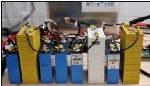
Bild 1: Eine mit ETA-Leveling betriebene Patchwork-Batterie: Alle Zellen sind gebraucht, teils haben sie mehrere Jahre gestanden, die größte Zelle verfügt über 68,6 Ah, die kleinste über 45,9 Ah.
